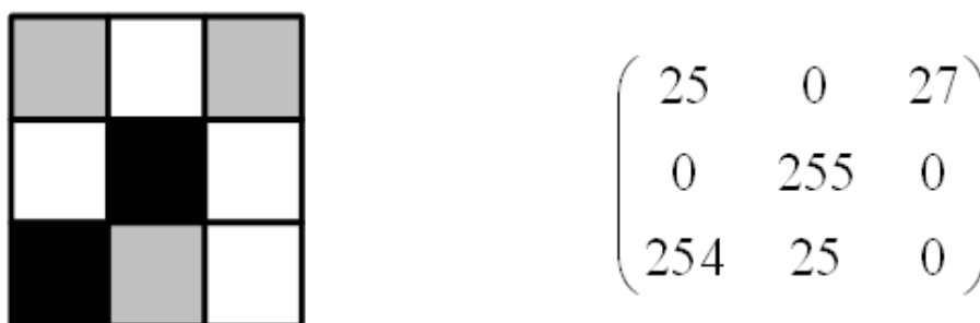
Рис. 1: Фрагмент изображения 3 × 3 (слева) и численные значения уровней серого в пикселях (справа)
